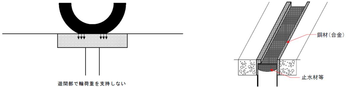
図-2.2.2.1 突合せ型鋼製伸縮装置の概要図
