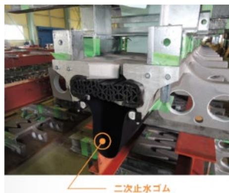
図-4.4.1.1 一体構造の二次止水構造例
